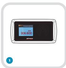
Com o auxílio de um medidor de frequência, ajuste a frequência do A3, para coincidir com a frequência do emissor original.
