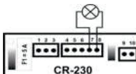
Deve-se utilizar um pirilampo sem electrónica 230VAC.
