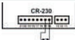
Contacto normalmente fechado, quando não utilizado deverá ser feita uma ponte entre o borne 14 ( comum) e o borne 15 (Stop).
