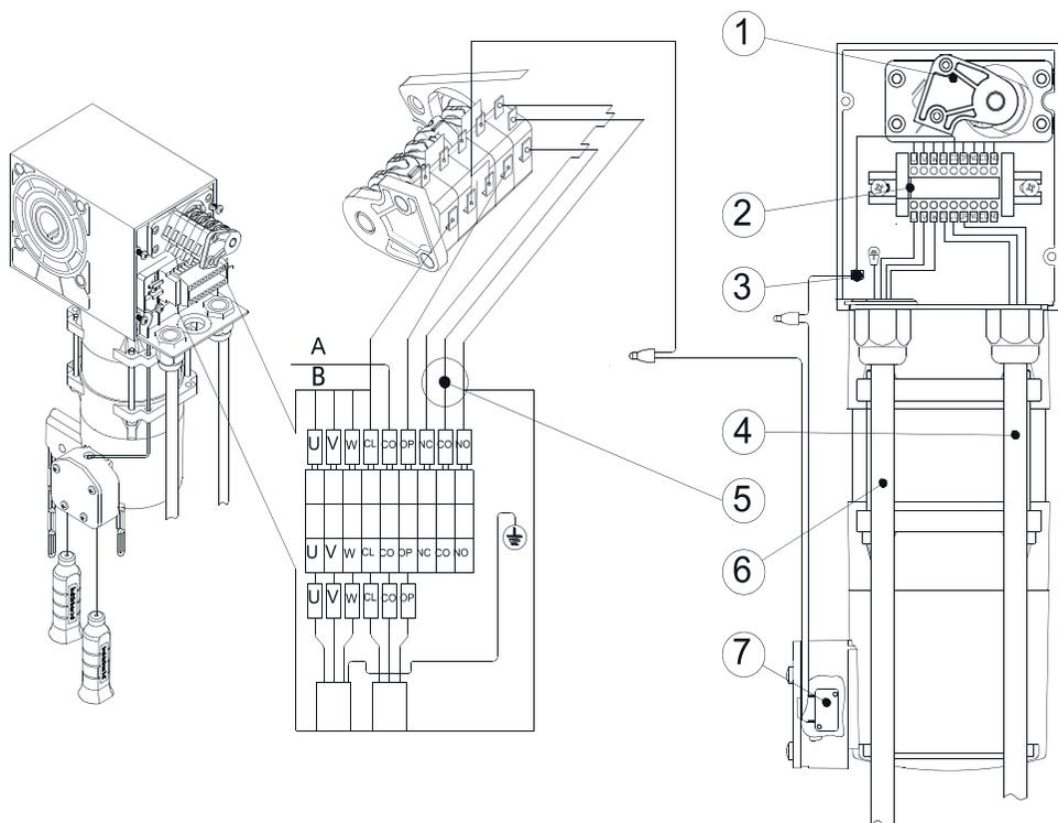
A Proteção térmica do motor
