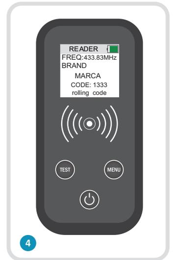
4 Quando o código escaneado se encontra na base de dados do identificador, este dará a informação da marca detentora do código assim como a sequência de quatro dígitos para introduzir no emissor ONEPRO. Torna-se mais fácil a programação do ONEPRO para ser adicionado ao recetor onde o emissor escaneado está programado.
