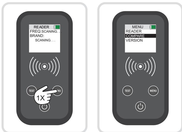
Quando se liga o equipamento este arranca em modo de escaneamento. Para aceder ao menu do equipamento pressione uma vez o botão menu.
