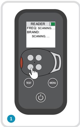
1 Coloque o emissor a ser escaneado sobre a zona de deteção. Mantenha o botão do emissor que pretende escanear pressionado.
