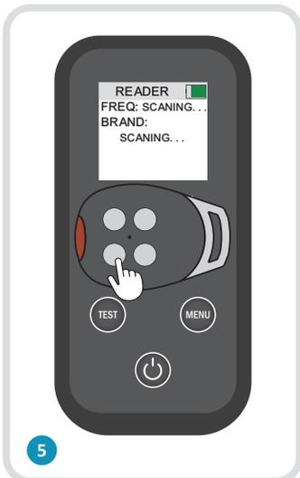
5 Nas marcas com código seed (código escondido) o identificador após detetar a marca irá também pedir a transmissão do respetivo código seed para validação da mesma. Proceda à emissão do respetivo código seed conforme as indicações do fabricante do emissor escaneado.
