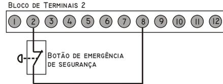
**N.B.:** Conecte os terminais 2 e 8 se, o botão de emergência STOP NÃO FÔR USADO.
