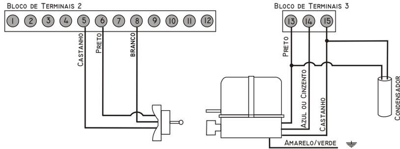
**NO CASO O MOTOR ESTÁ INSTALADO SOBRE O LADO ESQUERDO DO PORTÃO MUDAR OS CABOS DO MOTOR 13 COM O 15 E O CABO 5 COM O 6.**
