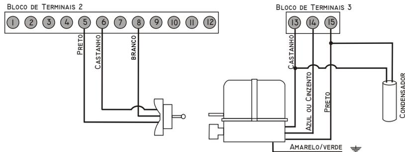
CONEXÕES DO MOTOR E FINS DE CURSO MAGNÉTICOS PARA MOTORES POSICIONADOS SOBRE O LADO DIREITO DO PORTÃO (vista interna)
